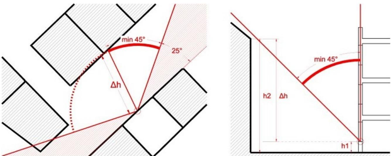
Obrázek 2: Příklad prokázání odstupového úhlu na situaci stavby
