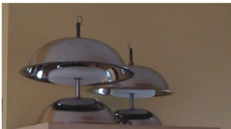
Obr. 4: Vlevo - Pasivní vzorkovač s PUF diskem, uzavřená varianta. Vpravo - schéma pasivního vzorkovače. Dvě misky z nerezové oceli spojené kovovou osou, která slouží k uchycení vzorkovače a ukotvení sorbentového disku uvnitř vzorkovače. Rozdílná velikost misek umožňuje volné proudění vzduchu kolem sorbentu a difuzi látek.
